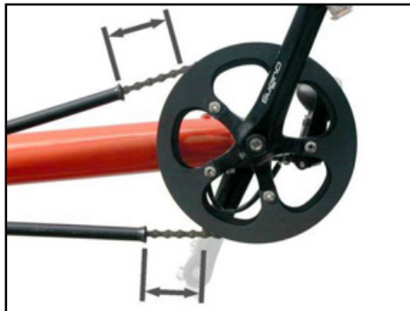
Zwischen den Enden der Kettenschutzrohre und den Schaltungsteilen müssen bei gespannter Kette mindestens 5 cm Abstand verbleiben.
