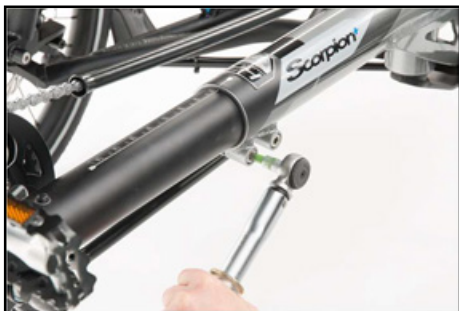
Klemmschrauben zum Verstellen des Tretlagerauslegers.
