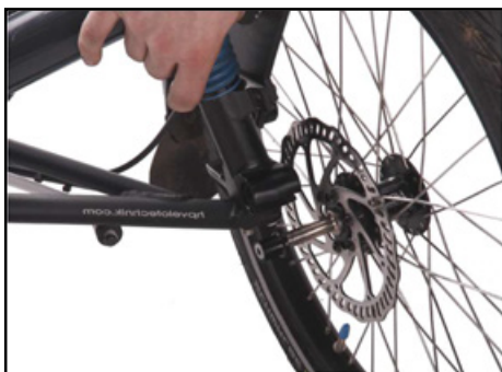
Vorderradausbau: Achse aus dem Radträger lösen
