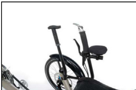
Rechte Aufstehhilfe zum Abstützen beim Aufstehen und Setzen.
