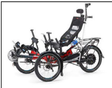
Scorpion plus 20: Eine Gehilfe kann mit dem Gehhilfenhalter am Rad befestigt und problemlos mitgeführt werden.
