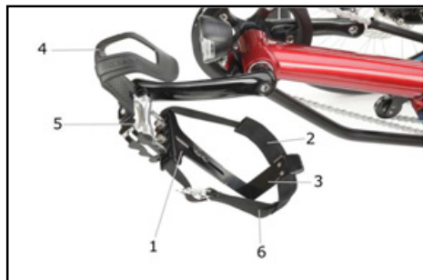
Fersenbandplatte (1), Fersenbandschlauch (2), Fersenbandhaken (3), Pedalkäfig (4), Pedal (5) und Fersenbandriemen (6)
