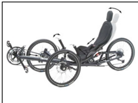
Verstellmöglichkeiten bei Dreirädern mit BodyLink-Sitzen.
