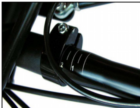
Die Verstellung von Lenkerneigung und -breite erfolgt über die Klemmschellen am Lenkervorbau.
