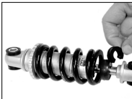
Durch das Aufstecken von Distanzclips auf die Kolbenstange des Federelementes wird der Federweg begrenzt.
