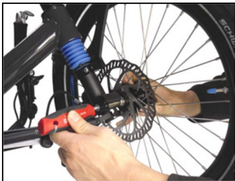
Vorderradausbau: Lösen der Schraube im Endstück
