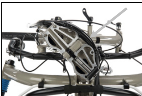
Die Kettenschutzrohre müssen zum Falten seitlich am Faltgelenk vorbeigeführt werden.
