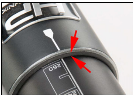
Zwischen dem Hauptrahmen und dem Tretlagerausleger muss die Distanzbuchse sichtbar sein.
