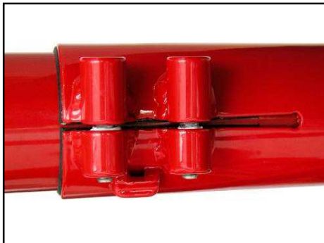
Beim Blick von unten in den Klemmschlitz darf das Ende des Tretlagerauslegers nicht sichtbar sein.
