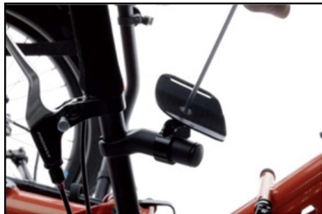
Ausrichten des Tellers der Handauflage
