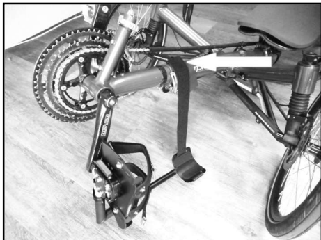
Positionierung des Klettstreifens als Halterung für die Unterschenkelfixierung
