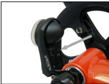
Die Beleuchtung beim Nabendynamo und bei elektrisch unterstützten Rädern wird mit dem Schalter am Scheinwerfer ein- und ausgeschaltet.
