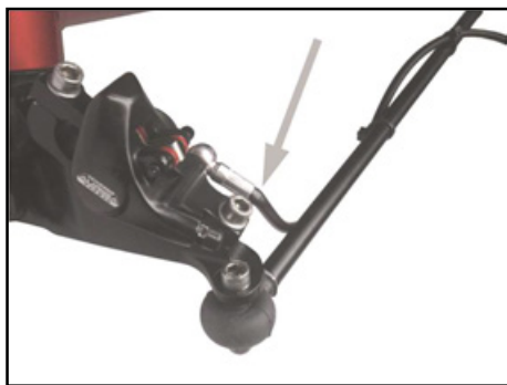
FALSCH: Der Bogen der Hydraulikleitung läuft vor der Spurstange: Gefahr des Abknickens (Pfeil).
