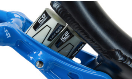
Doppel-Elastomer bei Adventure und Full Fat mit 26 Zoll
