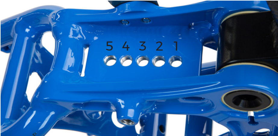
Einzel-Elastomer bei 20-Zoll-Trikes
