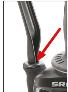
Bild 2: Der Pfeil zeigt, wo der Bremsgriff mit Silikon verschlossen wird
